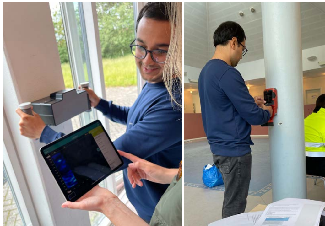
Fotos af DTU's arbejde med at dokumentere betonelementerne vha. en ikke-destruktiv metode (juni 2024).
